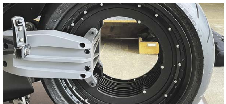
Der Radnabenmotor im Detail.
